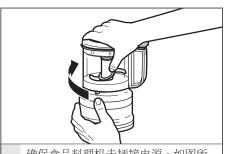
确保食品料理机未插接电源。如图所 **1** 示,按住杯盖然后顺时针旋转以解 锁。然后将加工杯的杯盖向上提起。
