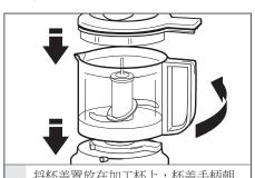
将杯盖置放在加工杯上,杯盖手柄朝 前。将杯盖手柄向右转动。逆时针旋 转杯盖,将其锁定到位。
