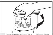
4 将杯盖置放在加工杯上,杯盖手柄朝前。将杯盖手柄向右转动。杯盖锁定时会卡入到位。逆时针旋转杯盖,将其锁定到位。
