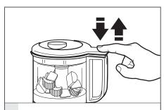
**2** 快速上下按压脉冲/开(脉冲/开启)按钮,使原料在加工杯中移动。
