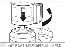
确保食品料理机未插接电源。从加工 杯手柄朝向底座前面开始。90°逆时 针旋转手柄,将其锁定到位。正确组 装后,手柄将朝向右侧。
