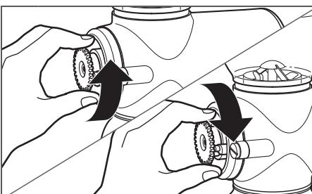
**5b** 如需最大的研磨粗度：逆时针转动研磨度控制齿轮，一次一格，直到咔哒声减弱，并且齿轮几乎没有转动阻力。
