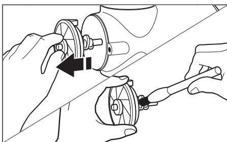
4 拔出刀盤軸總成以便清潔其他零件。使用刀盤清潔刷清潔刀盤軸總成上的刀盤，並清潔馬達機體中的刀盤。
