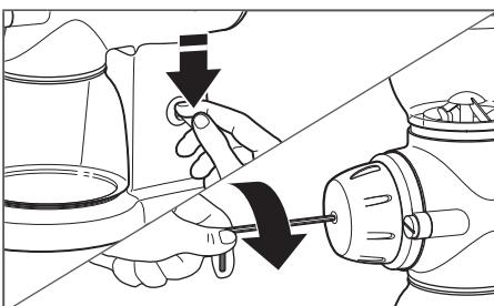
**6** 将电源开关扳到关闭位置。
