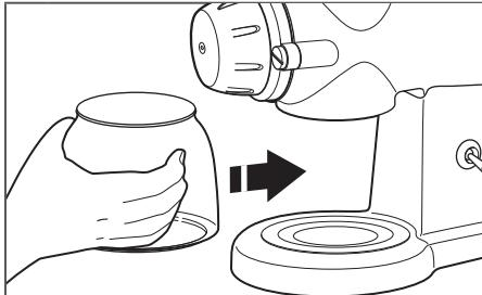
2 将咖啡粉罐滑到罐底座上，确保其居中放置。
