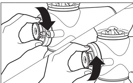
**5a** 如需最大的研磨细度：顺时针转动研磨度控制齿轮，一次一格，直到您听到表示刀盘触及的刮擦或摩擦声。然后，逆时针转动研磨度控制齿轮一格。刮擦或摩擦声将停止。
