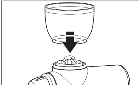
1 确保咖啡研磨机插头已拔下。将咖啡豆漏斗装到电机外壳顶部，顺时针转动，直到拧紧。
