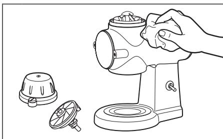
2 請務必用手清潔咖啡研磨機主機和主機零件。清潔時請使用柔軟的濕布，再以乾燥的軟布徹底擦乾。請勿放在洗碗機中清洗。請勿泡在水中。
